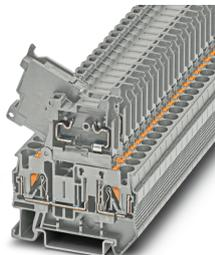
Borne de carril para fusible, tipo de fusible: Vidrio/cerámica/..., tipo de conexión: Conexión push-in, sección: 0,2 mm<sup>2</sup>- 6 mm<sup>2</sup>, AWG: 24 - 10, corriente nominal: 6,3 A, tensión nominal: 500 V, anchura: 6,2 mm, tipo de fusible: G/5 x 20, clase de montaje: NS 35/7,5, NS 35/15, color: gris
