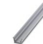
Carril simétrico sin perforar, Perfil estándar, anchura: 35 mm, altura: 15 mm, similar EN 60715, material: Aluminio, sin recubrimiento, longitud: 2000 mm, color: plateado
