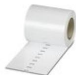
Marcador para bornes, Rollo, blanco, sin rotular, rotulable con: THERMOMARK ROLL 2.0, THERMOMARK ROLL, THERMOMARK ROLL X1, THERMOMARK ROLLMASTER 300/600, THERMOMARK X1.2, THERMOMARK S1.1, Perforado, clase de montaje: encajar en ranura de etiqueta universal, encajar en ranura para índice plana, para ancho de borne: 6,2 mm, superficie útil: 6,35 x 6,15 mm, Número de índices individuales: 16000
