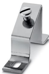
Soporte inclinado con tornillo M6, para la sujeción de los carriles en un ángulo de 30°, altura: 46 mm
