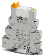
PLC-INTERFACE, compuesto de borne de base PLC-BSC.../21 con conexión por tornillo y relé en miniatura enchufable para corrientes constantes elevadas, para montar sobre carril NS 35/7,5, corriente constante límite hasta 10 A, 1 contacto conmutado, tensión de entrada 24 V DC
