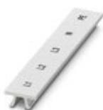
Tira Zack, Tiras, blanco, rotulado, rotulación longitudinal: L1, L2, L3, N, PE, clase de montaje: encajar en ranura para índice alta, para ancho de borne: 12,2 mm, superficie útil: 10,5 x 12,15 mm, Número de índices individuales: 5
