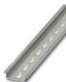
Carril simétrico perforado, según EN 60715, material: Acero, galvanizado, pasivado de capa gruesa, Perfil estándar, color: plata
