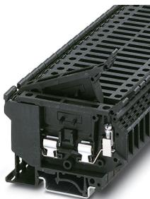
Borne de carril para fusible, Para la rotulación de bornes utilice el material de marcado con división de 8,2 mm., tipo de fusible: Vidrio/cerámica/..., tipo de fusible: G/5 x 20/5 x 25/5 x 30, tensión nominal: 800 V, corriente nominal: 6,3 A, número de polos: 1, tipo de conexión: Conexión por tornillo, Sección de dimensionamiento: 1 mm<sup>2</sup>, sección: 0,2 mm<sup>2</sup>- 4 mm<sup>2</sup>, clase de montaje: NS 35/7,5, NS 35/15, NS 32, color: negro
