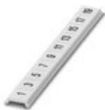
Tira Zack plana, Tiras, blanco, rotulado, rotulación longitudinal: Números impares 1-19, 21-39 etc. hasta 81-99, clase de montaje: encajar en ranura para índice plana, para ancho de borne: 5 mm, superficie útil: 5,15 x 5,15 mm, Número de índices individuales: 10
