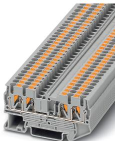
Borne de paso, tensión nominal: 800 V, corriente nominal: 24 A, número de conexiones: 4, tipo de conexión: Conexión push-in, 1er piso, Sección de dimensionamiento: 2,5 mm<sup>2</sup>, sección: 0,14 mm<sup>2</sup> - 4 mm<sup>2</sup>, clase de montaje: NS 35/7,5, NS 35/15, color: gris
