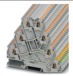
Borne para motores, cuatro pisos, tipo de conexión: conexión push-in, sección transversal: 0,2 mm² - 6 mm², AWG: 24 - 10, ancho: 6,2 mm, altura: 95,4 mm, color: gris, tipo de montaje: NS 35/7,5, NS 35/15
