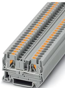
Borne de paso, tensión nominal: 800 V, corriente nominal: 32 A, número de conexiones: 2, tipo de conexión: Conexión push-in, 1er piso, Sección de dimensionamiento: 4 mm<sup>2</sup>, sección: 0,2 mm<sup>2</sup> - 6 mm<sup>2</sup>, clase de montaje: NS 35/7,5, NS 35/15, color: gris
