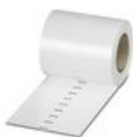
Marcador para bornes, Rollo, blanco, sin rotular, rotulable con: THERMOMARK ROLL 2.0, THERMOMARK ROLL, THERMOMARK ROLL X1, THERMOMARK ROLLMASTER 300/600, THERMOMARK X1.2, THERMOMARK S1.1, Perforado, clase de montaje: encajar en ranura de etiqueta universal, encajar en ranura para índice plana, para ancho de borne: 6,2 mm, superficie útil: 6,35 x 6,15 mm, Número de índices individuales: 16000
