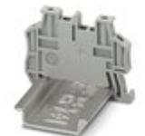
Soporte final de montaje rápido, para carril simétrico NS 35/7,5 o carril simétrico NS 35/15, con posibilidad de marcado, con posibilidad de aparcamiento para FBS...5, FBS...6, KSS 5, KSS 6, ancho: 5,15 mm, color: gris
