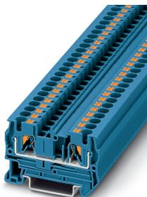
Borne de paso, tensión nominal: 800 V, corriente nominal: 32 A, número de conexiones: 2, tipo de conexión: Conexión push-in, 1er piso, Sección de dimensionamiento: 4 mm<sup>2</sup>, sección: 0,2 mm<sup>2</sup> - 6 mm<sup>2</sup>, clase de montaje: NS 35/7,5, NS 35/15, color: azul
