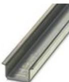
Carril simétrico sin perforar, Perfil estándar, anchura: 35 mm, altura: 15 mm, similar EN 60715, material: Acero, galvanizado, pasivado de capa gruesa, longitud: 2000 mm, color: plateado
