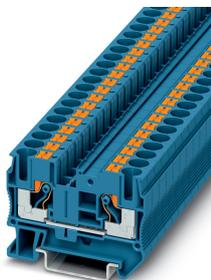
Borne de paso, tensión nominal: 1000 V, corriente nominal: 41 A, número de conexiones: 2, tipo de conexión: Conexión push-in, 1er piso, Sección de dimensionamiento: 6 mm<sup>2</sup>, sección: 0,5 mm<sup>2</sup> - 10 mm<sup>2</sup>, clase de montaje: NS 35/7,5, NS 35/15, color: azul
