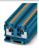
Borne de paso, tensión nominal: 1000 V, corriente nominal: 57 A, número de conexiones: 2, tipo de conexión: Conexión push-in, Sección de dimensionamiento: 10 mm², sección: 0,5 mm² - 16 mm², clase de montaje: NS 35/7,5, NS 35/15, color: azul
