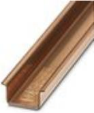
Carril simétrico sin perforar, Perfil estándar, anchura: 35 mm, altura: 15 mm, similar EN 60715, material: Cobre, sin recubrimiento, longitud: 2000 mm, color: de color cobre
