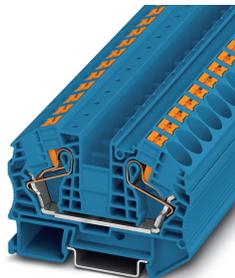
Borne de paso, tensión nominal: 1000 V, corriente nominal: 76 A, número de conexiones: 2, tipo de conexión: Conexión push-in, 1er piso, Sección de dimensionamiento: 16 mm<sup>2</sup>, sección: 0,5 mm<sup>2</sup> - 25 mm<sup>2</sup>, clase de montaje: NS 35/7,5, NS 35/15, color: azul
