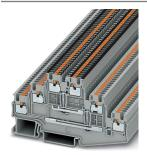
Borne multipiso, con empalmadores de potencial, tensión nominal: 500 V, corriente nominal: 15 A, tipo de conexión: Conexión push-in, 1er piso, Sección de dimensionamiento: 1,5 mm², sección: 0,14 mm² - 1,5 mm², clase de montaje: NS 35/7,5, NS 35/15, color: gris
