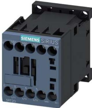
Contactor de potencia, AC-3 7 A, 3 kW/400 V 1 NA, 24 V DC 3 polos, tamaño S00 conexión por tornillo
