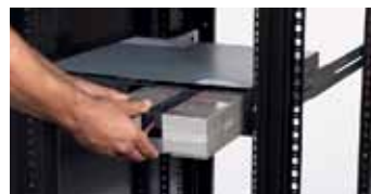
Las baterías del SAI Eaton 5PX son intercambiables en caliente.
