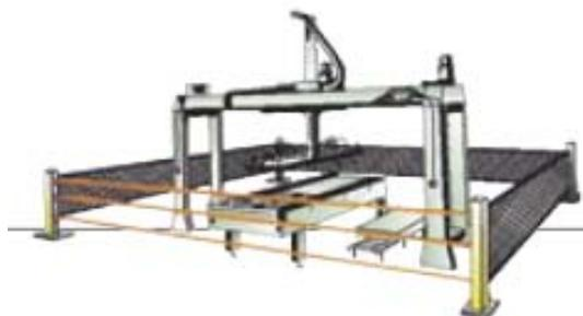
Protección del cuerpo en máquinas automáticas
