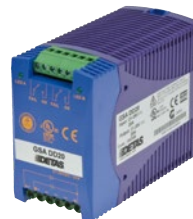
Montabile su guida DIN Adatto per sistemi ridondanti di 24 VAC max. 20 A Contatti a relè Diodi di disaccoppiamento LED indicatore di allarme per guasto in ingresso
