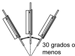
Si coloca este producto con una inclinación superior a 30°, la temperatura ambiente no debe superar los 40 °C (104 °F). Puede que sea necesario utilizar un sistema de enfriamiento por aire forzado (ventilador, aire acondicionado) para garantizar que la temperatura ambiente de funcionamiento sea de 40 °C o menos (104 °F o menos).
