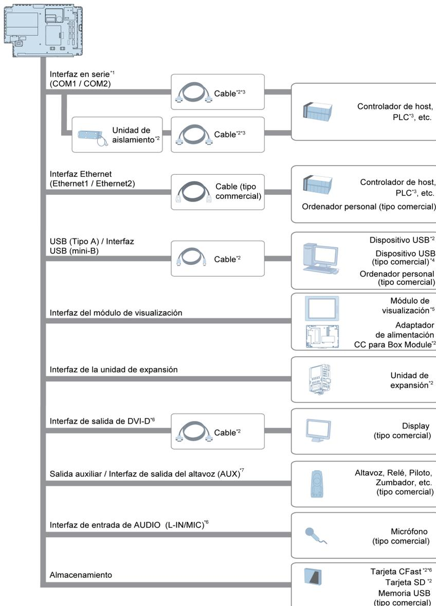
\*1 Con el fin de utilizar este puerto como un puerto aislado, se requiere una Unidad de Aislamiento. Para usar una unidad de aislamiento RS-232C, establezca el pin #9 del puerto COM en VCC. (en Standard Box, conecte la unidad de aislamiento a COM1 y en otros equipos de Box Module conéctela a COM2).
