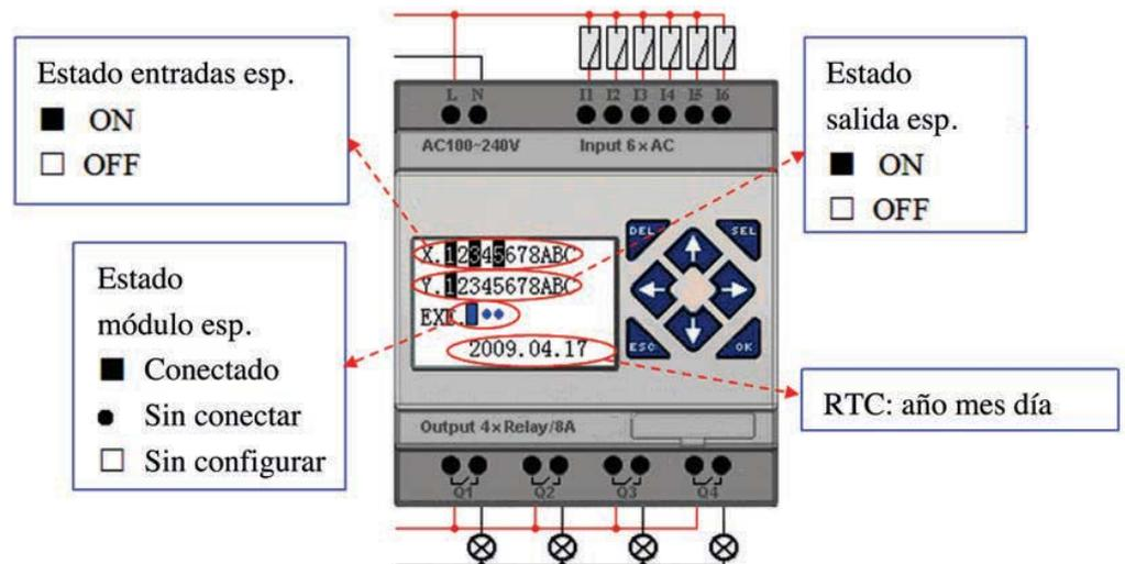
Tanto el módulo de expansión digital como el módulo de expansión analógico cuentan con LEDs. Los estados de los LEDs son idénticos, como se muestra a continuación.
