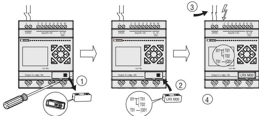
3. Mediante el teclado del lado frontal del LRD, seleccionar ESCRIBIR o LEER para transmitir el programa a la memoria LRXM00 o del módulo de memoria LRXM00 al LRD.
