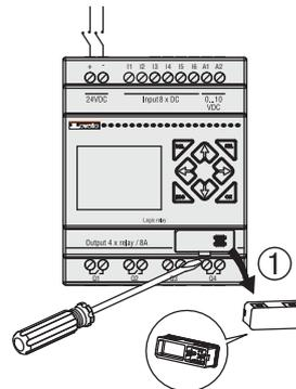
Introducir el extremo del conector plástico del cable de programación (LRXC00 para PC RS232 o LRXC03 para PC USB) en el LRD como se muestra en la siguiente figura.
