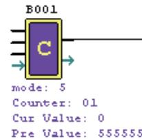
Nota: Sólo las primeras 31 funciones del contador mantienen el valor actual tras un fallo de alimentación del LRD.
