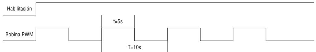
El estado de M01, M02 y M03 determina la salida PWM. Las etapas PWM pueden modificarse mediante el estado de M01, M02 y M03 con P01 activo.
