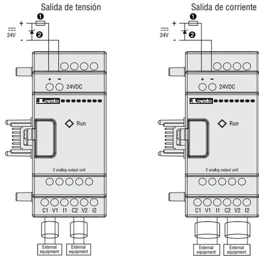
El modo de salida puede configurarse mediante el LRD básico, con los valores de los registros DR (valor actual):
