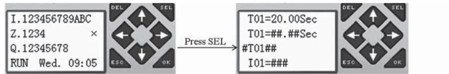
1b. Estado funcionamiento HMI: La HMI se habilita en base a la condición del programa usuario (memoria M02).
