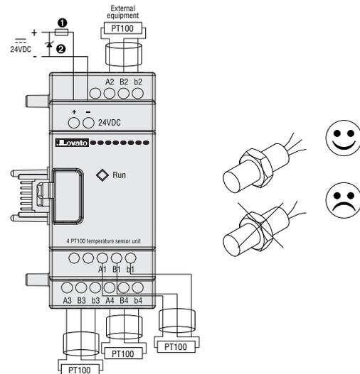
Cuando la temperatura supera los límites del rango  $-100^{\circ}\text{C} \dots +600^{\circ}\text{C}$ , se activan (ON) las bobinas de error M34, M35, M36 y M37, que corresponden al canal 1, canal 2, canal 3 y canal 4.
