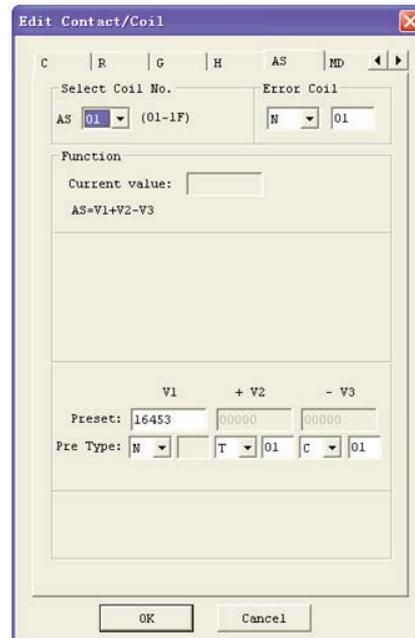
La bobina de salida de error N01 se activa cuando el resultado del cálculo es excesivo.
