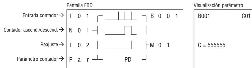
Nota: "PD" significa que el valor actual se mantiene hasta que se restablece la alimentación; el contador mantiene el valor actual cuando LRD conmuta entre RUN y STOP con la opción 'C con memoria retentiva' activada.
