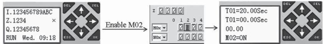
2. Estado preparación modificación HMI: Pulsar SEL cuando la HMI esté en estado de barrido o ejecución; el cursor parpadeante indica los valores modificables.
