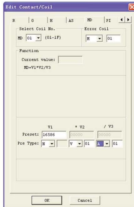
La bobina de salida de error M01 se activa cuando el resultado del cálculo es excesivo.
