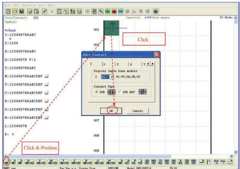
Las teclas o los iconos "A" y "L" se utilizan para completar circuitos seriales y paralelos. La columna a la derecha de la cuadrícula de programación se refiere a las bobinas de salida.
