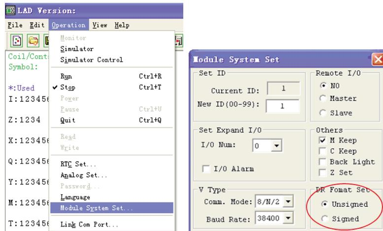
A continuación de las operaciones mencionadas, el entorno de modificación Data Register se abre seleccionando la opción del menú Modificar>> Configurar Data Register... ilustrada abajo. El valor configurado de DR puede ser una constante o un código formado por otros datos.
