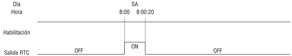
El tiempo actual será 8:00:00 cuando llegue por primera vez a 8:00:20; el bit de estado RTC R01 se pondrá en ON. El bit de estado RTC R01 se pondrá en OFF cuando el tiempo actual llegue por segunda vez a 8:00:20. La temporización proseguirá, por tanto el bit de estado RTC se mantendrá en ON durante 21 segundos.
