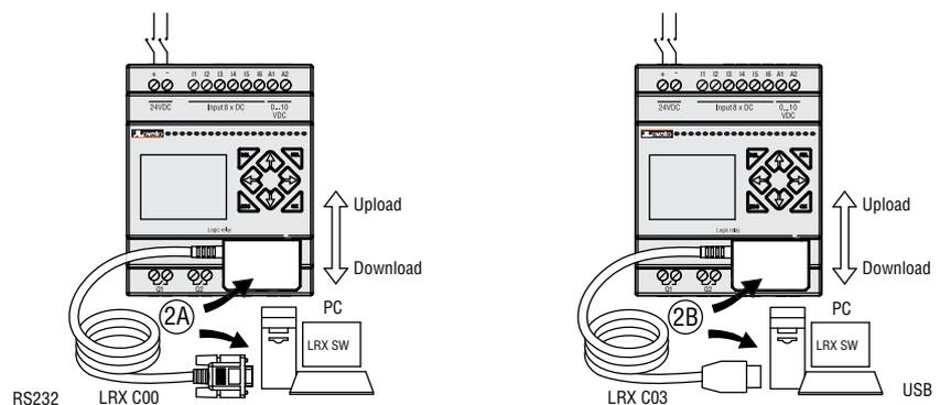
Conectar el otro extremo del cable en un puerto serial RS232 del PC o USB del PC.
