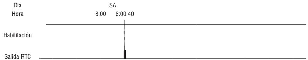
El tiempo actual pasará a 8:01:00 cuando llegue a 8:00:40; el bit de estado RTC R01 se pondrá en ON. La temporización proseguirá y R01 pasará a OFF, por tanto el bit de estado RTC se mantendrá en ON por un pulso.
