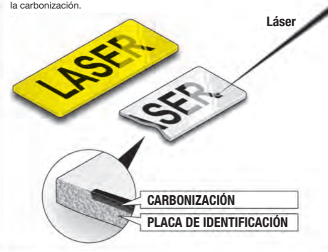
La gran calidad de la rotulación láser de pulsar es el resultado de una reacción química en el material identificado.
