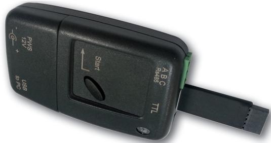
El dispositivo KEY USB se utiliza para la programación en serie de controladores que deben tener la misma configuración de parámetros, o para guardar una copia de la programación del controlador y poder transferirla rápidamente.
