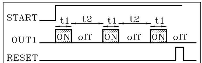
F1 = 4 - Pausa-reactivación (oscilador) asimétrica con start OFF:
