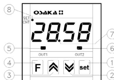
**1 – Tecla set:** Utilizada para la programación de los set point y para la programación de los parámetros de funcionamiento.
