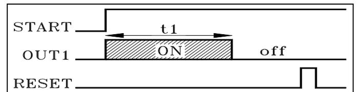
F1 = 3 - Pausa-reactivación (oscilador) asimétrica con start ON:
