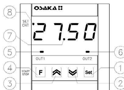
**1 – Tecla Set:** Utilizada para la programación de los set point y para la programación de los parámetros de funcionamiento.
