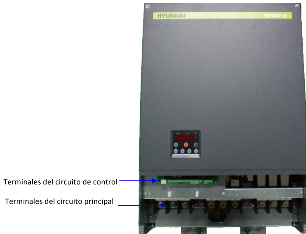
Fig1-6 Vista sin cubierta frontal
