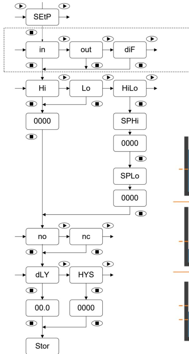
**Si el generador de consigna analógico está habilitado,** el relé de alarma puede configurarse para activarse con un valor de la señal de entrada ("in"), con la salida analógica ("out") o bien con el valor absoluto de la diferencia en unidades de ingeniería entre la entrada y la salida ("diF").
