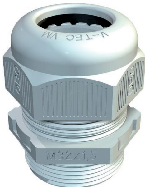
La forma más rápida y cómoda de conseguir la descarga de tracción y buena estanqueidad mediante la utilización de prensaestopas en cajas de derivación y carcasas: los eficaces prensaestopas V-TEC VM de OBO. Con el cierre hermético integrado y la especial tecnología de lengüetas de OBO, se logra alcanzar la clase de protección IP68. La descarga de tracción y la estanqueidad se verifican según la norma EN 50262.
