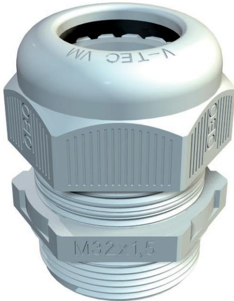
La forma más rápida y cómoda de conseguir la descarga de tracción y buena estanqueidad mediante la utilización de prensaestopas en cajas de derivación y carcasas: los eficaces prensaestopas V-TEC VM de OBO. Con el cierre hermético integrado y la especial tecnología de lengüetas de OBO, se logra alcanzar la clase de protección IP68. La descarga de tracción y la estanquidad se verifican según la norma EN 50262.
