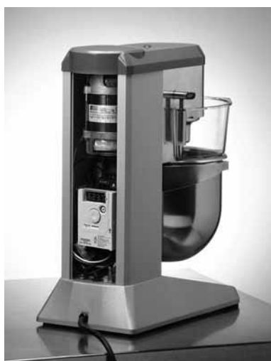
ATV 12 para control de un mezclador
