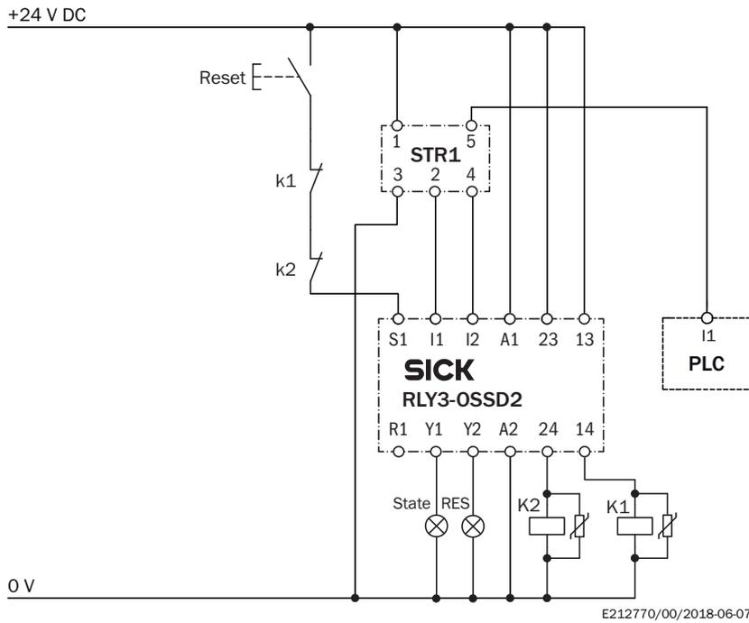
Dos interruptores de seguridad con transpondedor STR1 en conexión paralela con un controlador de seguridad Flexi Classic
