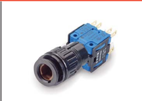
Selector, 3 posiciones, saliente, ruptura brusca, redondo, plástico negro, 18mm Ø
