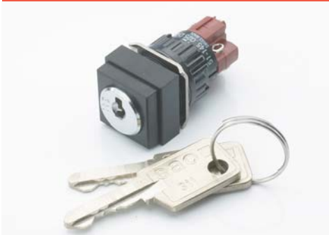
Conmutador a llave, 2 posiciones, saliente, ruptura brusca, cuadrado, plástico negro, 18 x 18mm
