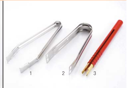
Extractor de caperuzas para marco plano, extractor de caperuzas para marco saliente y extractor de LED
