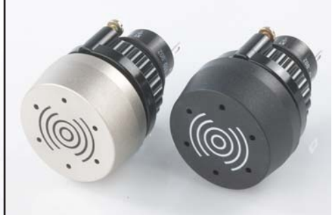
Zumbador, frontal plástico, saliente, montaje 22,5mm, 24VDC, IP65, 95dB ± 8 a una distancia de 0.1m
