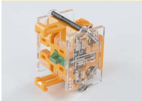
Cámara contactos, terminales de tornillo, rupt. brusca, contactos autolimpiantes de plata
