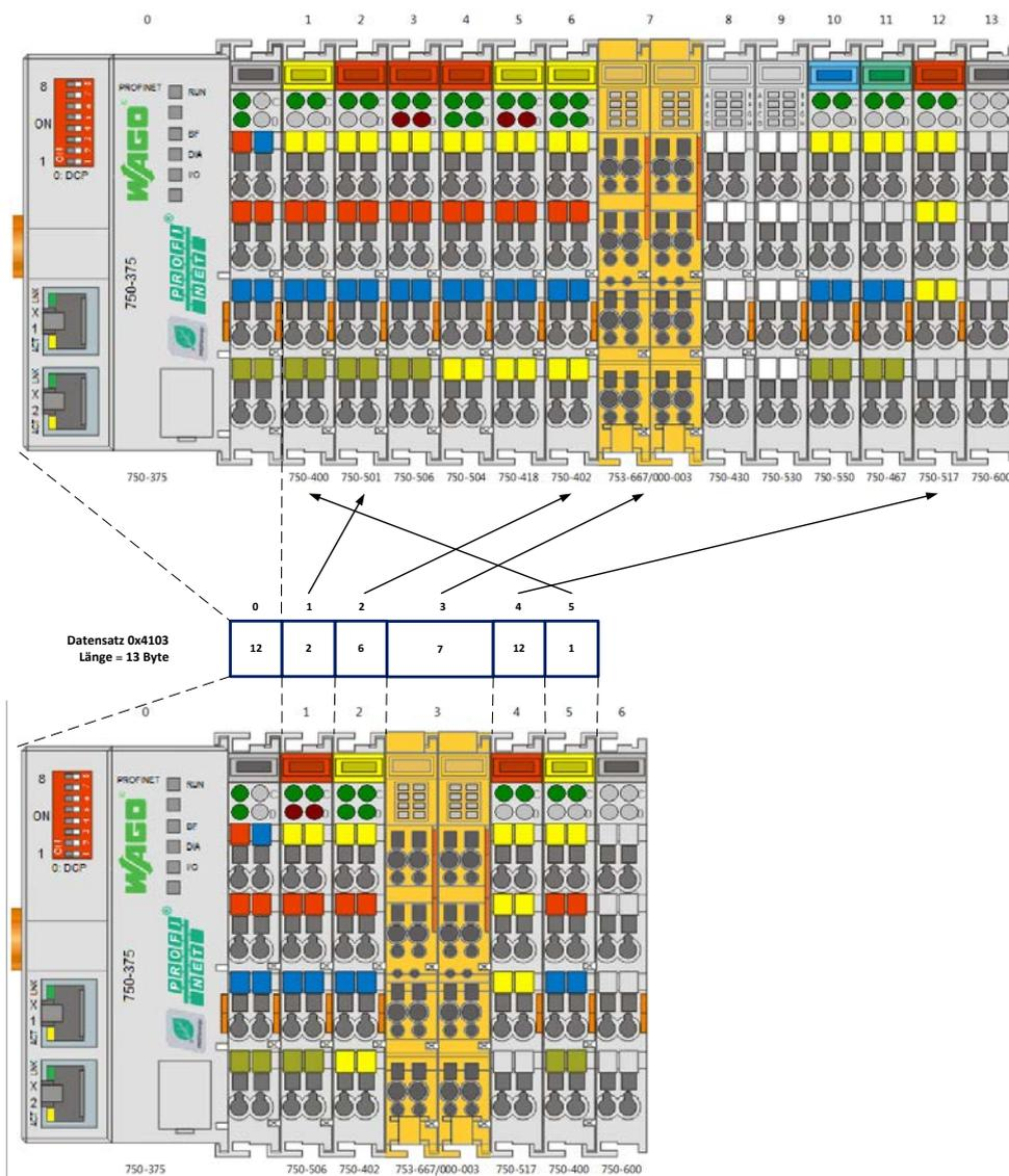
Abbildung 52: Abbildung eines physikalischen auf den projizierten Stationsausbau
