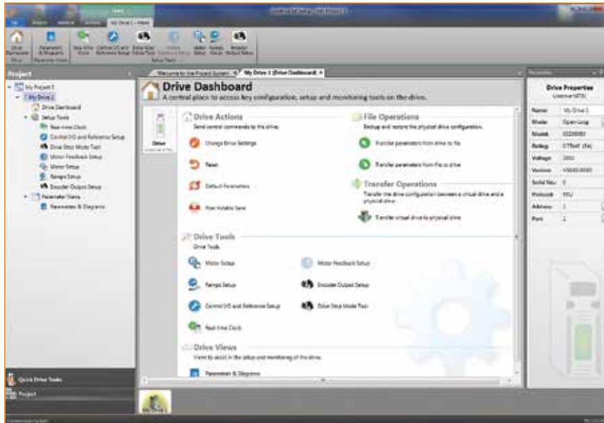
Pantalla de la herramienta de configuración del accionamiento Unidrive M y el motor
